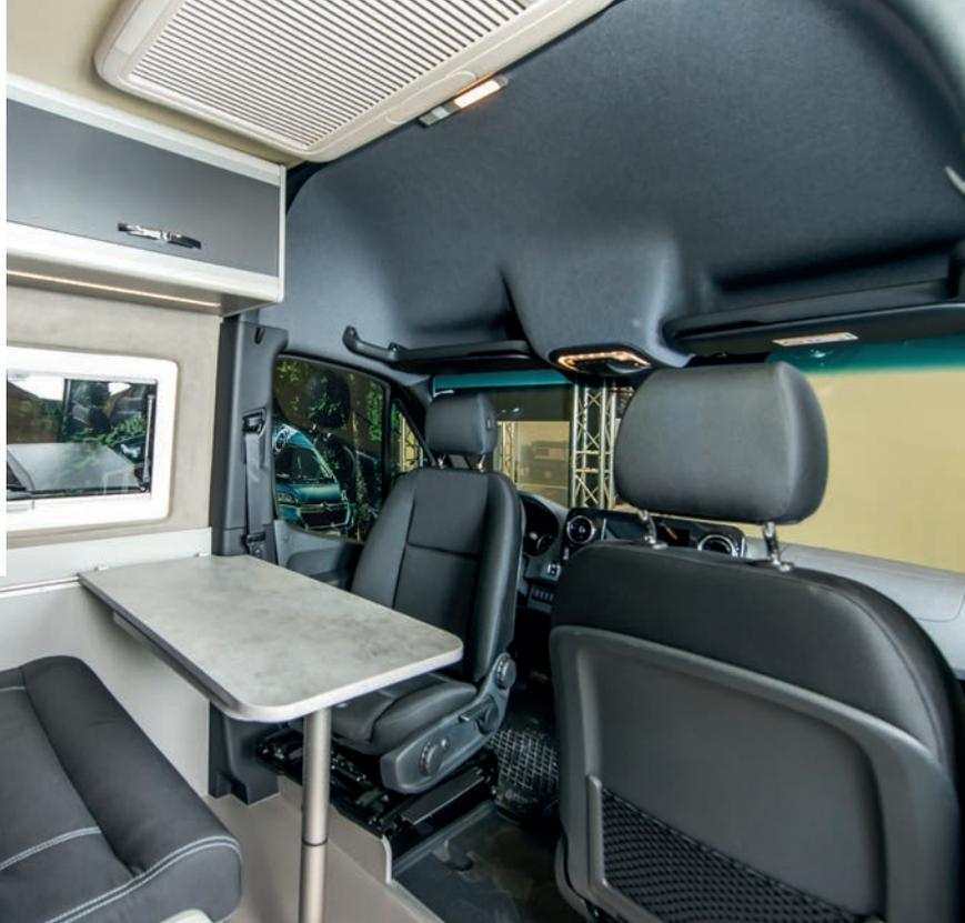
**Premium Ausbauhölzer** - Hier setzt MegaMobil serienmäßig auf die besonders kratzfeste CPL-Oberflächenbeschichtung in Kombination mit 15mm starkem Pappelsperholz in verschiedenen Designs. Schubladen mit Vollauszug, Soft-Close und verdeckte Laufschienen sowie Premium-Scharniere von Blum an den Oberschränken runden den Möbelbau ab.
