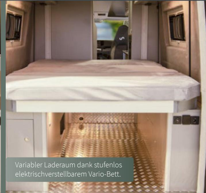
Variabler Laderaum dank stufenlos elektrischverstellbarem Vario-Bett.
