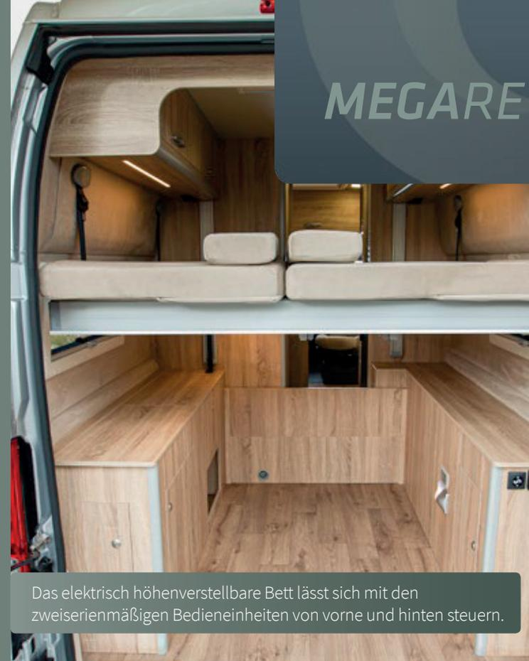
Das elektrisch höhenverstellbare Bett lässt sich mit den zweierienmäßigen Bedieneinheiten von vorne und hinten steuern.
